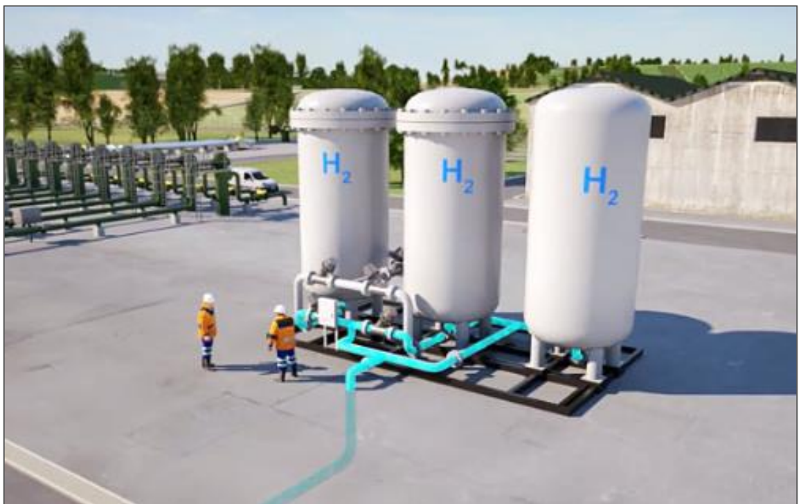
Figur2-10. Exempel på trycksatta lagringsbehållare för lagring av vätgas. Källa: Hybrit. Exempel på en trycksatt vätgasbehållare finns nedan.
