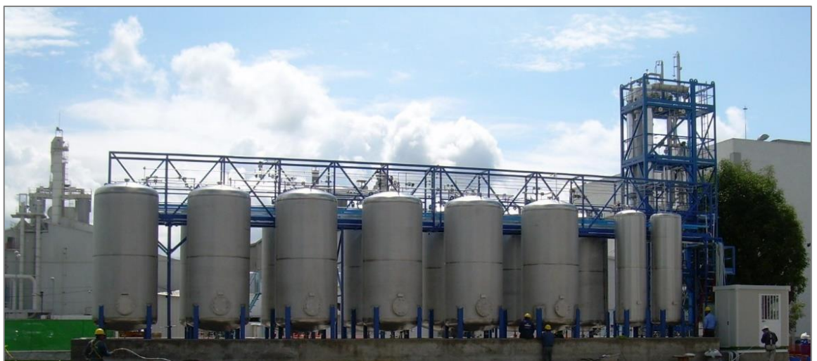
Figur2-13. Exempel på ett storskaligt metanollager.
