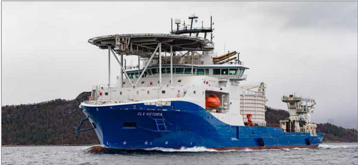
Figur1-12. Fartyg för utläggning av sjökablar (bild: NKT).
