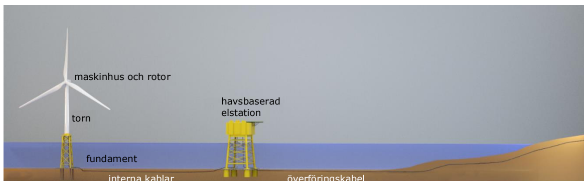
Figur1-3. Exempel på olika delar av vindkraftsparken till havs.
