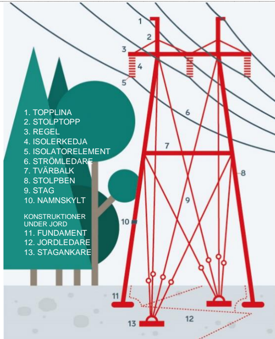
Figur 1-5. Kraftledningens delar (Fingrid 2021).
