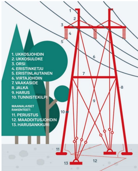
Kuva 1-5. Voimajohdon osat (Fingrid 2021).
