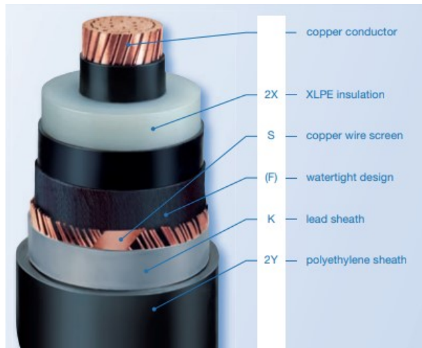
Figur 17. Principskiss enfaskabel för markförläggning. Källa: NKT.
