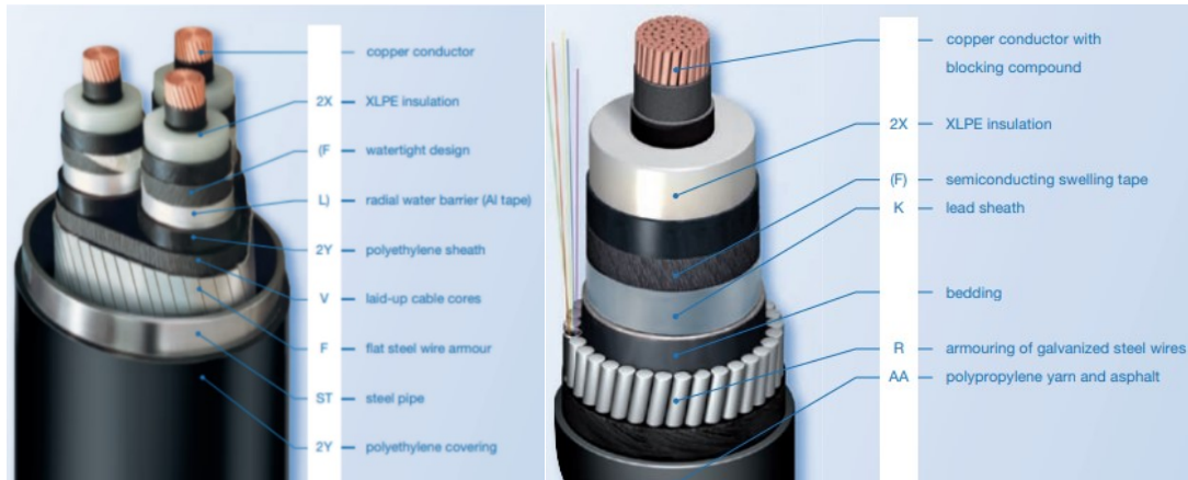
Figur 14. Principskiss för trefaskabel respektive enfaskabel med växelström. Källa: NKT.
