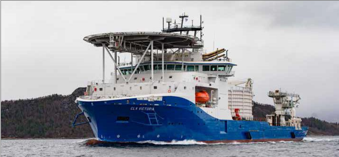
Kuva 3-12. Merikaapeleiden asennusalus (kuva: NKT).
