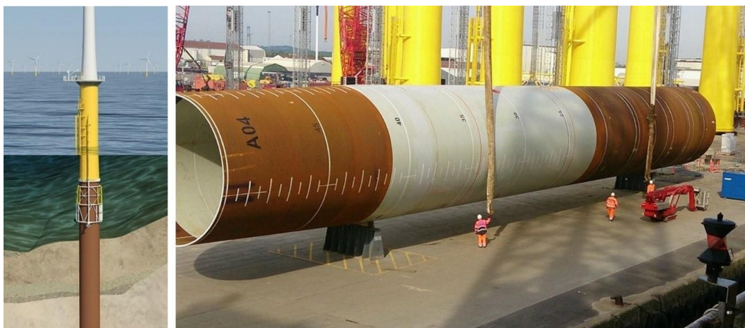
Figur 9. Till vänster: illustration av ett färdigt installerat monopilefundament. Till höger: tillverkning av monopilefundament. I bakgrunden syns färdiga övergångsstycken. Källa: COWI
