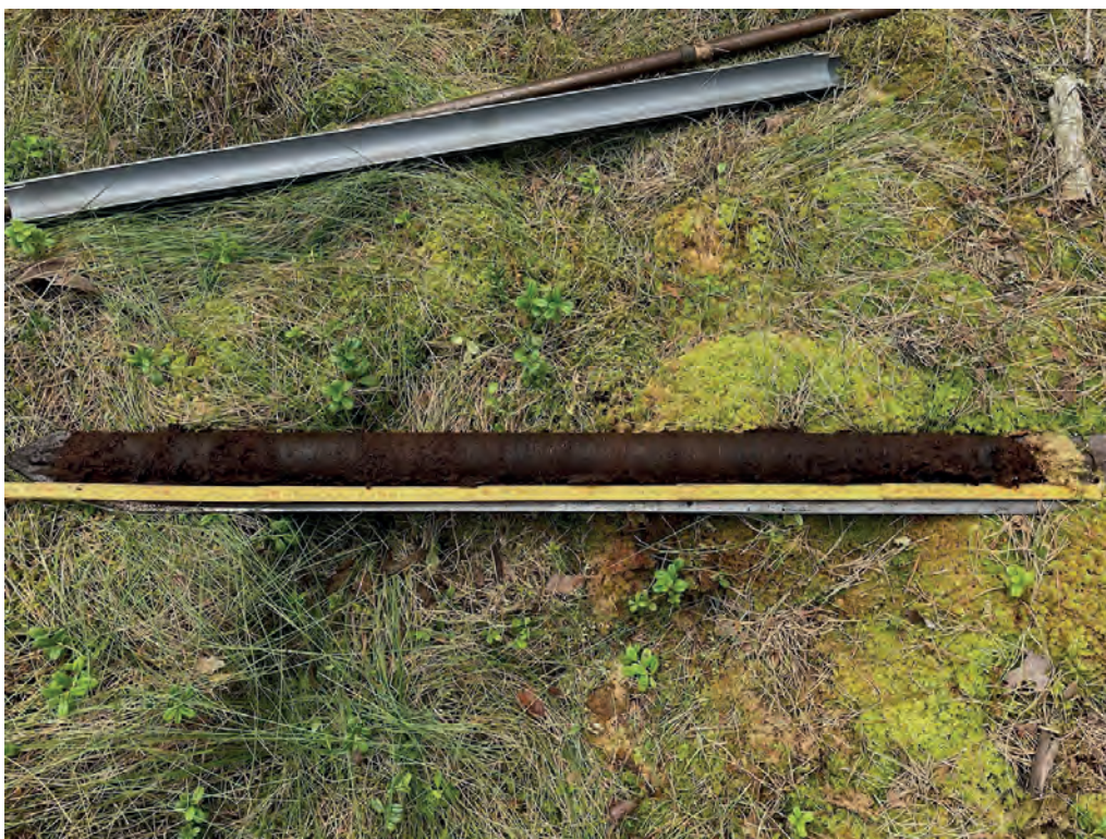
Figur 4. På bilden syns borrhkannen med den provtagna lagerföljden (mellan nivåerna 0–100 cm) som helt utgörs av vitmosstörv, huvudsakligen av låg- eller medelhumifierad typ (se tabell 1). Uppåt är till höger i bilden. Foto: Leif Björkman, 2021-07-05.
