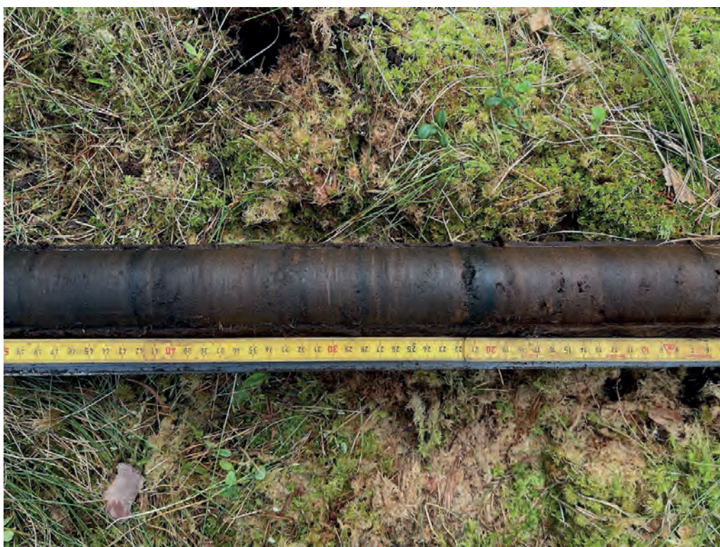
Figur 10. Detaljbild på avsnittet mellan 314–350 cm där det finns ett antal både smala och breda lager med träkolspartiklar som avspeglar bränder som rimligen ägt rum under mellanmesolitikum. Uppåt är till höger i bilden. Foto: Leif Björkman, 2021-07-05.
