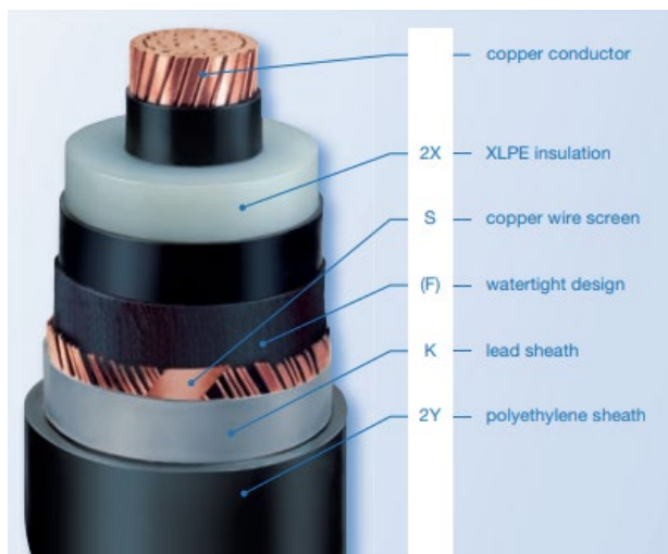
Figur 10. Prinsipskiss mark enfaskabel, växelström och likström. Källa: NKT.
