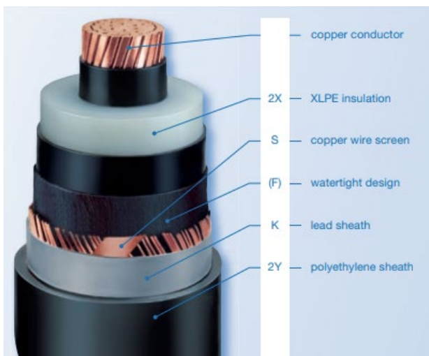
Figur 10. Principskiss mark enfaskabel, växelström och likström. Källa: NKT.
