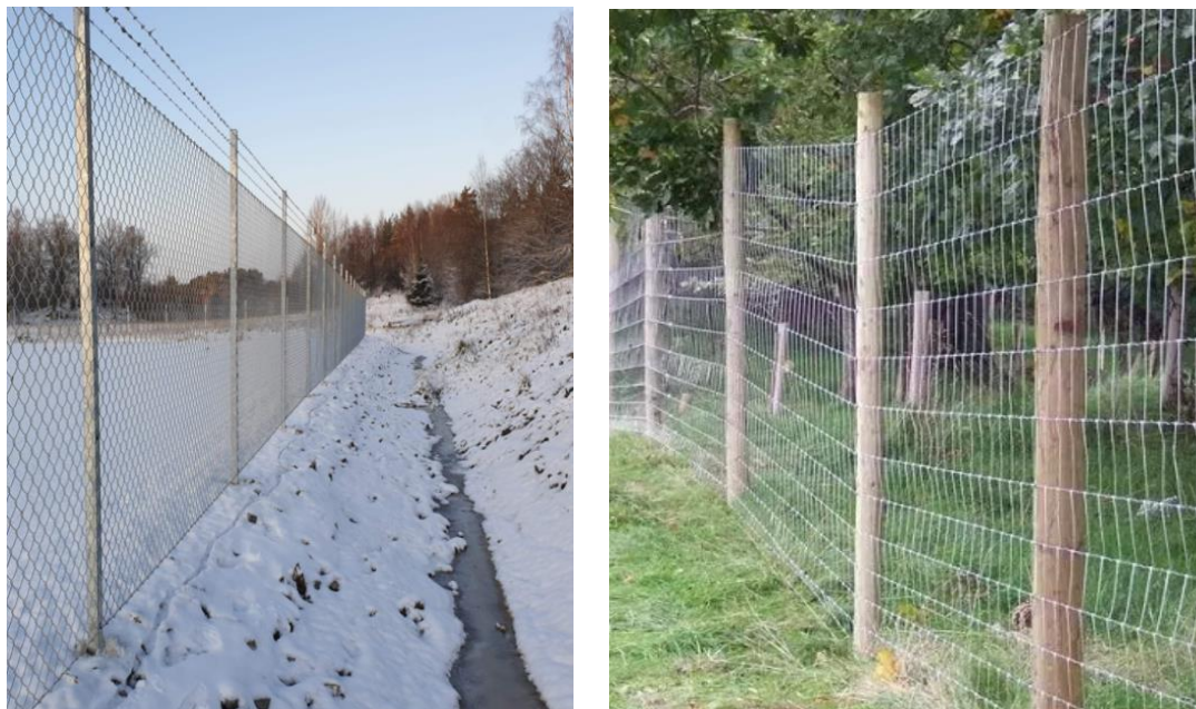
Figur 7. Exempel på industristängsel (vänster, bildkälla www.mmstangsel.se ) och viltstängsel (höger, bildkälla www.bole.se ).
