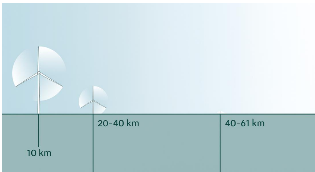
Figur 5. Schematisk bild som visar avstånd och synlighet med hänsyn tagen till jordens krökning för vindkraftverk som är 290 meter höga. Datakälla: OX2 AB.
