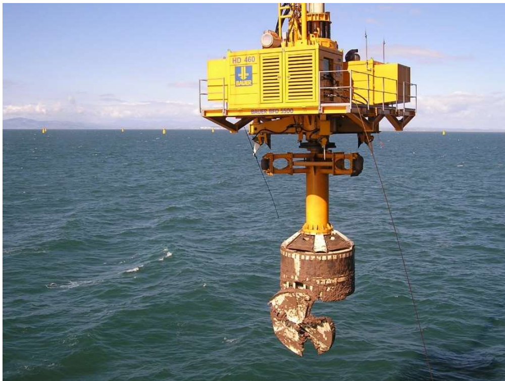
Figur 13. Exempel på borrh som kan användas vid borrhning av pålar. (Källa Bauer Group)
