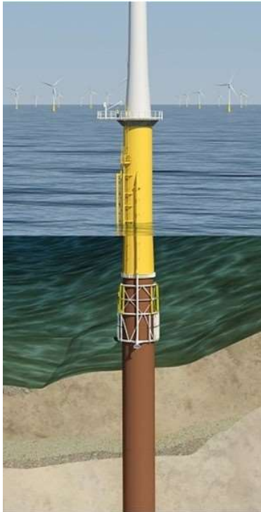
Figur 11. Illustration av monopilefundament (Källa COWI).
