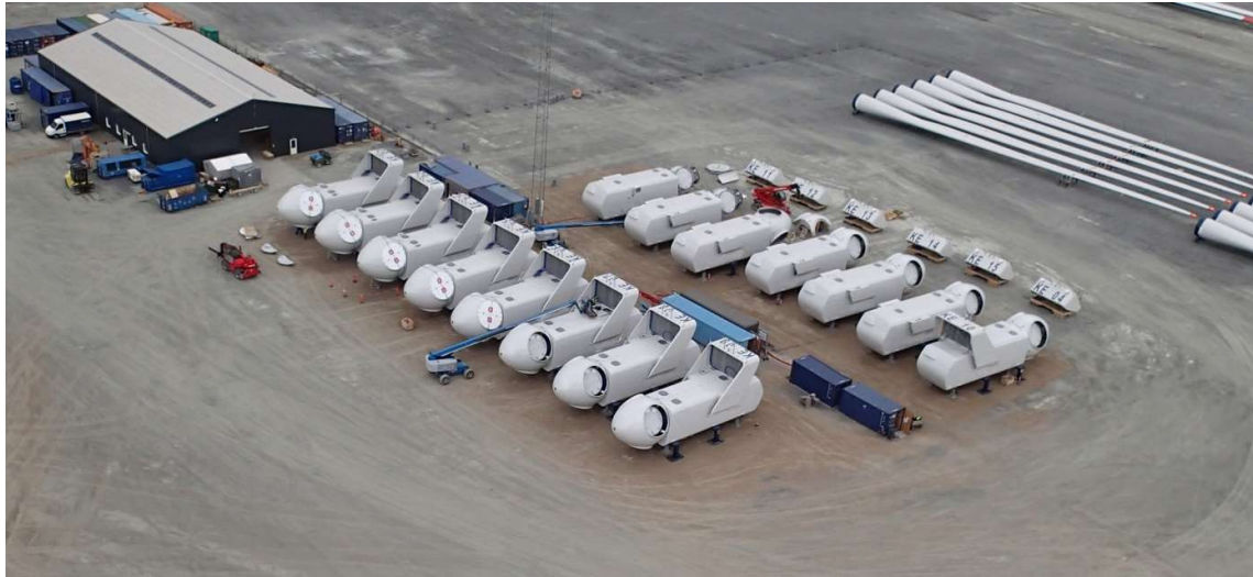
Figur 31. Maskinhus som vid slutmonteringshamnen färdigställs för installation (Källa: privat).
