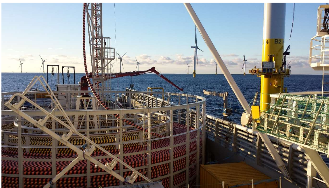
Figur 24. Kabeltrumma på kabellägningsfartyg.
